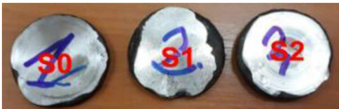
Butoni prelucrați prin strunjire din aliaje cu entropie ridicată
